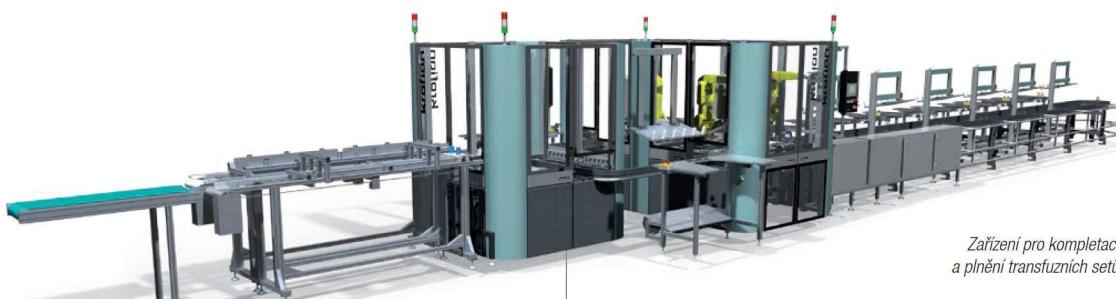
Zařízení pro kompletaci a plnění transfuzních setů
